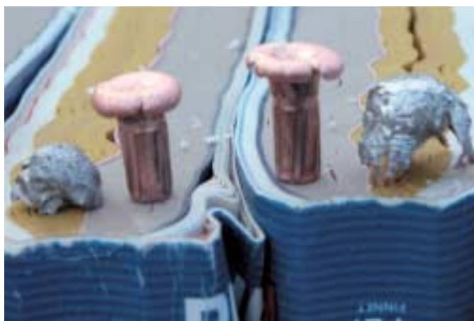
Zum Vergleich: herkömmliches Teilmantel-Geschoss, zwei Naturalis-Geschosse, Verbundkern-Geschoss (v. l.) nach dem Telefonbuch-Test
