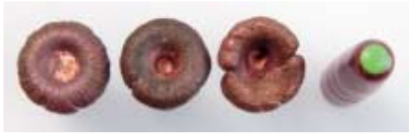
„Naturalis“-Geschossreste (Kaliber .30): nach Gelatinebeschuss mit Knochen, nach Gelatinebeschuss ohne Knochen, aus Großem Kudu geborgen. Zum Vergleich ein delabiertes Geschoss (v. l.)
