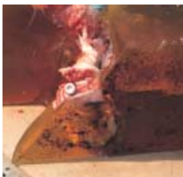
Frühes Ansprechen und gute Tiefenwirkung zeigt der Blick auf einen aufgeschnittenen Gelatineblock, nachdem er auf 50 Meter mit einem 11,7 Gramm Naturalis (.30-06) beschossen wurde
