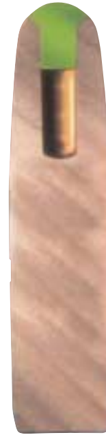
Deutlich zu erkennen: der Kunststoffeinsatz und die „Hohlspitze“ des Geschosses
