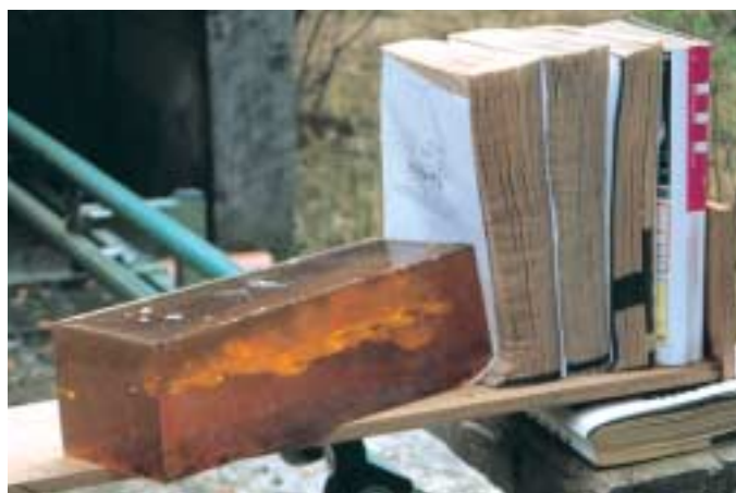
So erfolgte der Gelatinebeschluss: Hinter dem Gelatine-Block wurde das Geschoss durch Telefonbücher aufgefangen
